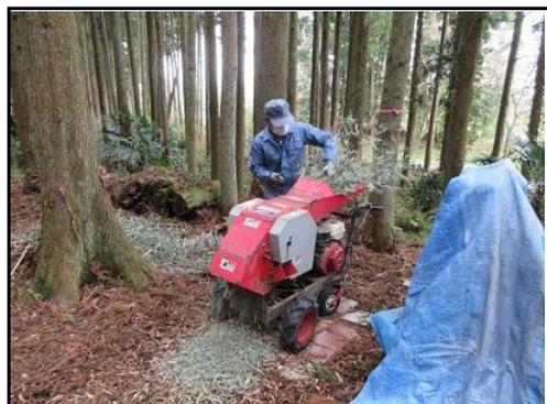
Vベルト交換後の試運転、粉碎作業
